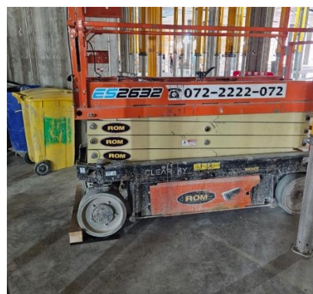
Мобильный отбойник, чтобы оборудование не могло случайно что-то ударить.
